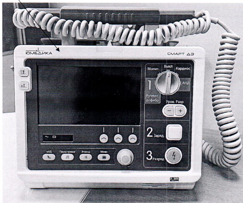
Рисунок 2.1 – Схема (рисунок) с указанием места для нанесения знака поверки на дефибриллятор-монитор «СМАРТ ДЗ»
