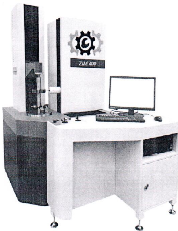
Рисунок 1.2 – Фотография общего вида зубоизмерительных машин ZIM 400 (изображение носит иллюстративный характер)
