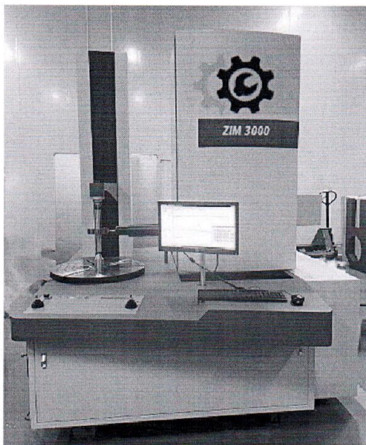
Рисунок 1.7 – Фотография общего вида зубоизмерительных машин ZIM 3000 (изображение носит иллюстративный характер)
