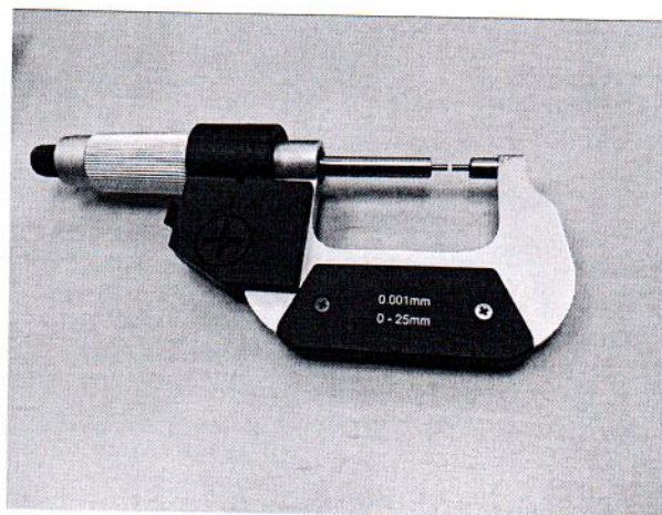
Рисунок 1.1 – Фотография общего вида микрометра МКЦ-МП-25
