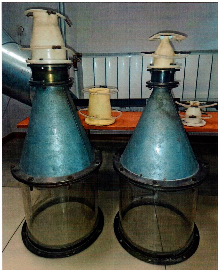
Рисунок 1.2 – Фотография общего вида сменных сопел-конфузоров (насадок) для измерения малых скоростей из состава стенда
