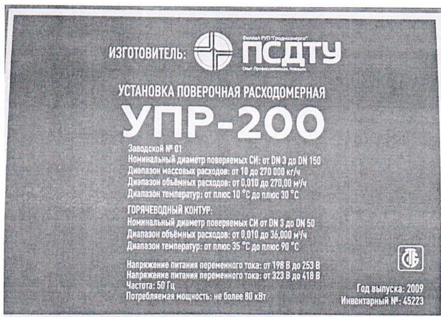
Рисунок 1.2 – Фотография маркировки установки поверочной расходомерной УПР-200 № 01
