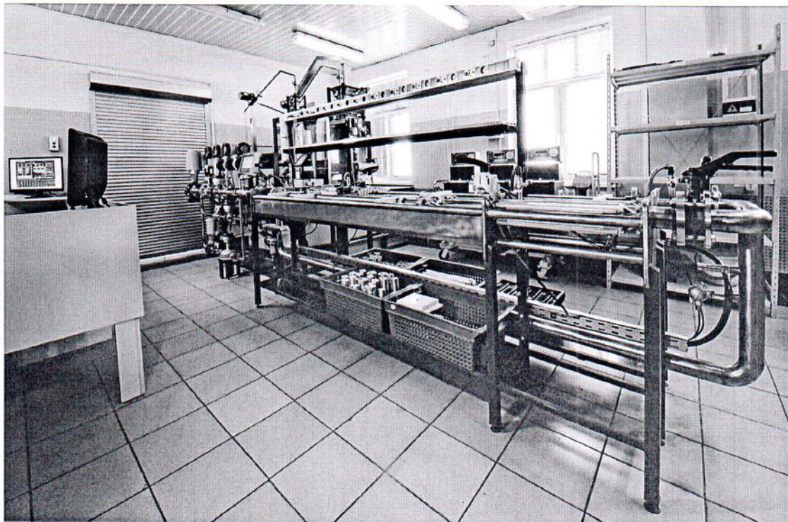
Рисунок 1.1 – Фотография общего вида установки для поверки расходомеров и счетчиков жидкости «УПР-200 измерительная линия № 3» № 001-1
