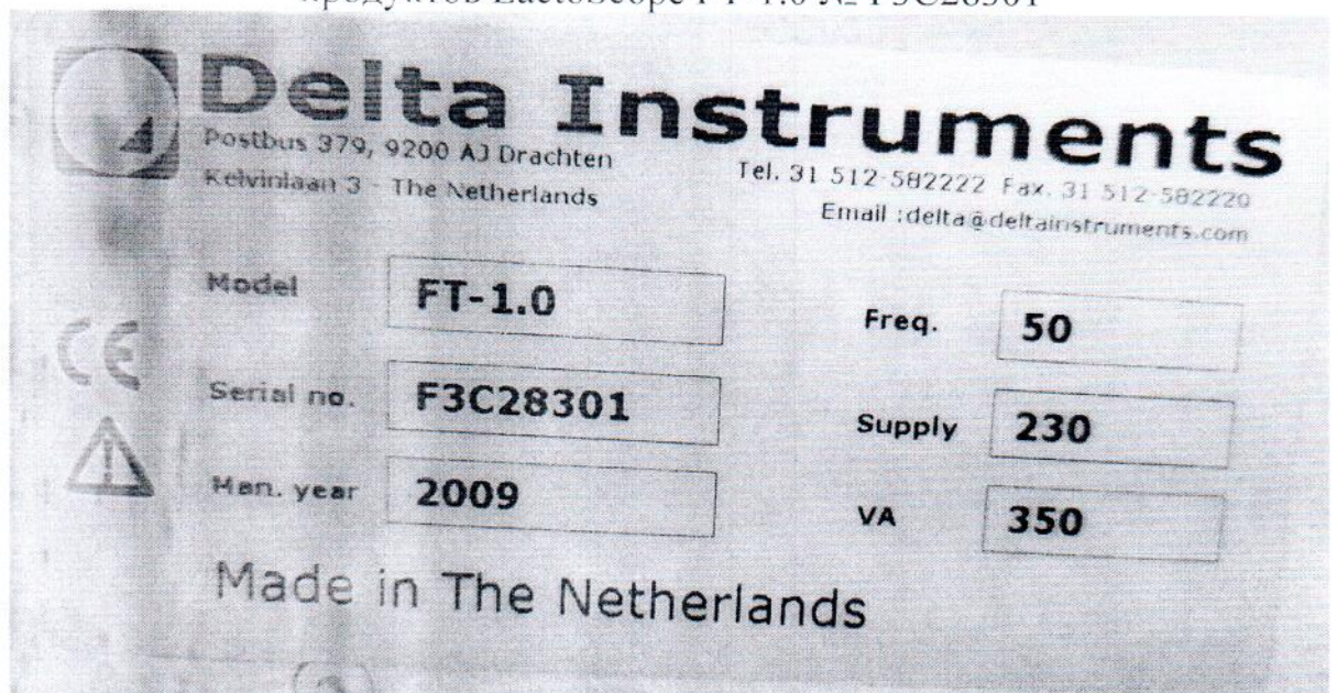
Рисунок 1.2 – Фотография маркировки анализатор молока и молочных продуктов LactoScope FT-1.0 № F3C28301
