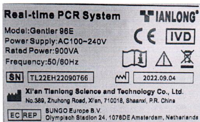
Рисунок 1.2 – Фотография маркировки термоциклеров для проведения полимеразной цепной реакции (ПЦР) в режиме реального времени: систем для ПЦР в реальном времени Gentier 96E (изображение носит иллюстративный характер)
