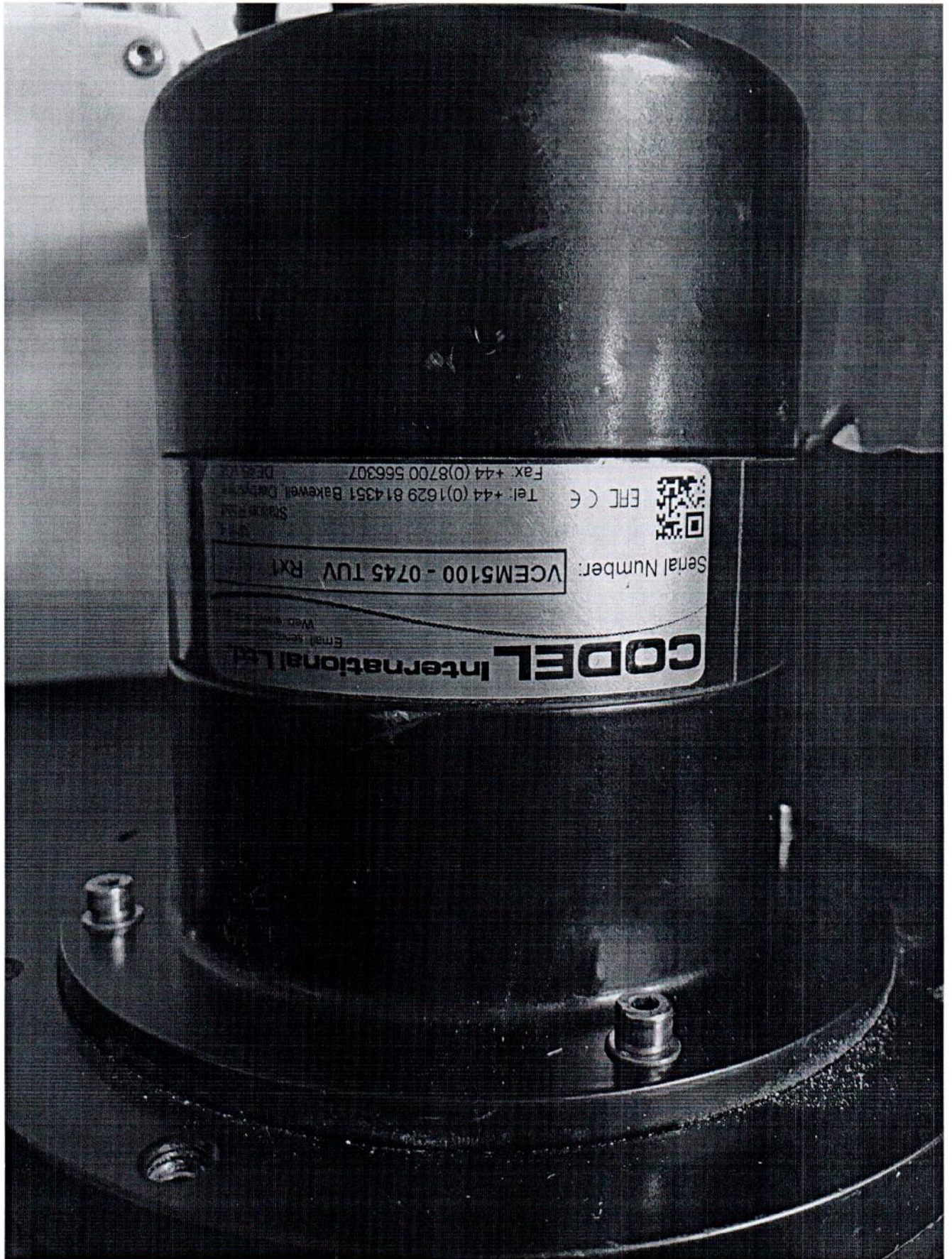
Рисунок 1.2 – Фотография первого инфракрасного датчика. Измеритель скорости газовоздушных потоков VCEM5100 № VCEM5100 – 0745 TUV SPU
