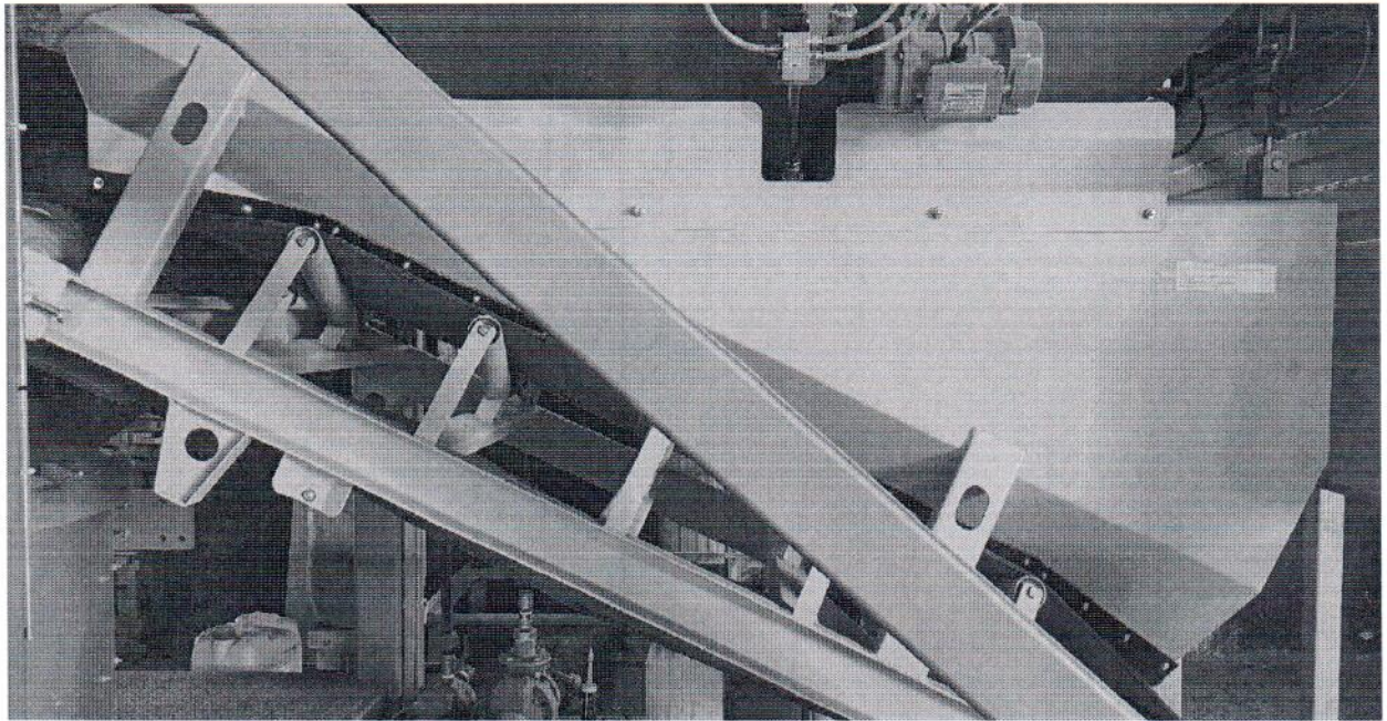
Рисунок 1.1 – Внешний вид дозатора весового автоматического дискретного действия ДВДД-И-800 № 2204
