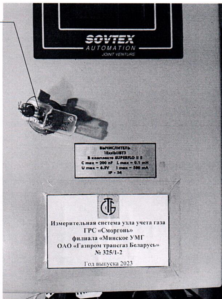
Рисунок 3.1 – Схема пломбировки от несанкционированного доступа
