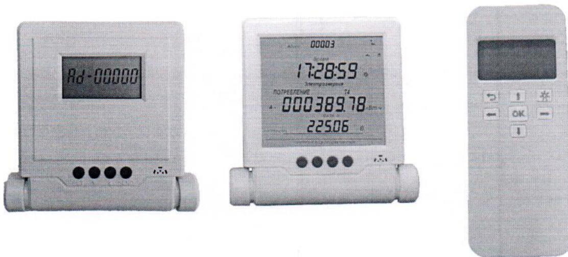
Рисунок 1.3 – Фотография общего вида счетчика «MIRETEK-1-BY-SP» в типе корпуса SP3
