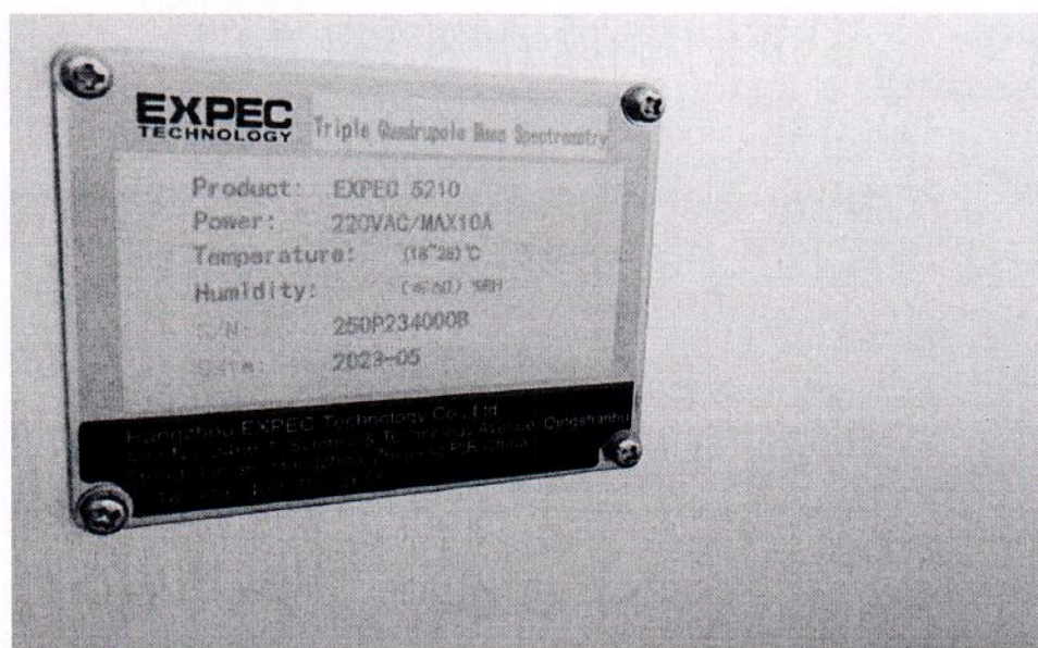
Рисунок 1.2 – Фотография маркировки хромато-масс-спектрометра жидкостного EXPEC 5210 № 250P2340008
