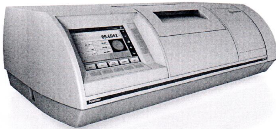
Рисунок 1.1 – Фотография общего вида поляриметра MCP 200 Sucromat № 82006280
