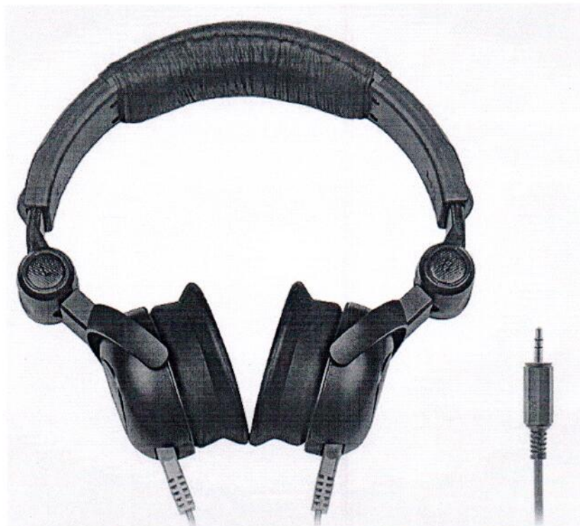
Рисунок 1.13 – Слуховой стимулятор комплекса компьютерного многофункционального для исследования ЭЭГ, ВП и ЭМГ «Нейрон-Спектр-5/S», «Нейрон-Спектр-5», «Нейрон-Спектр-4/ВПМ» (носит иллюстративный характер)
