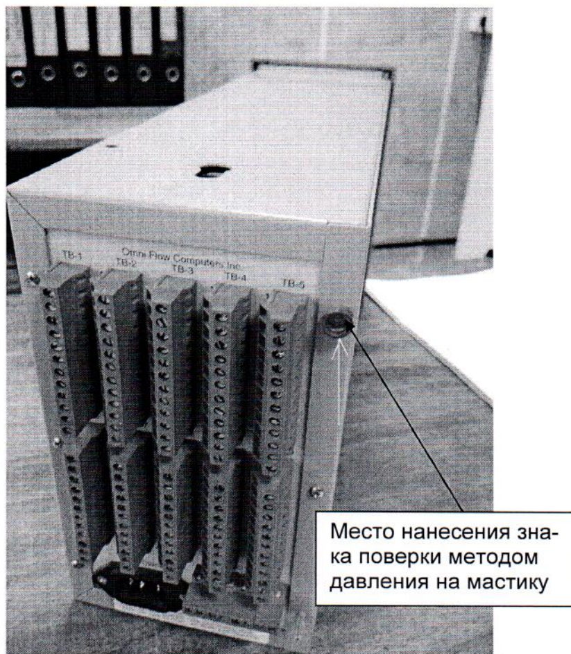
Рисунок 2.3 – Схема с указанием места нанесения знака поверки методом давления на мастику
