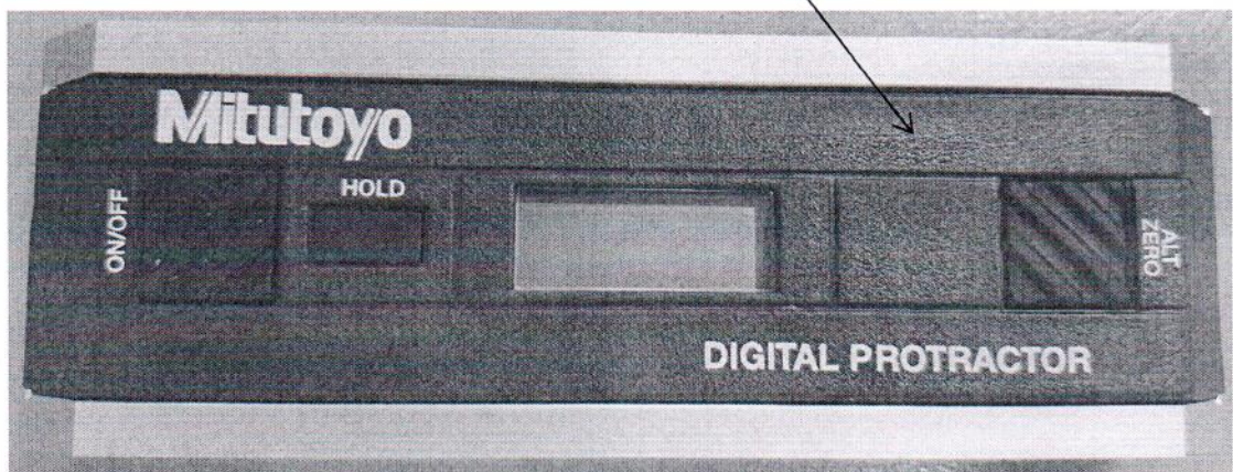
Рисунок 2.1 - Схема (рисунок) с указанием места для нанесения знака поверки для прибора цифрового прецизионного Pro 3600 № 23010137
