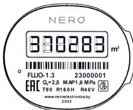
Рисунок 1.2 – Схема маркировки счётчиков воды крыльчатых FLUO-1 (изображение носит иллюстративный характер)
