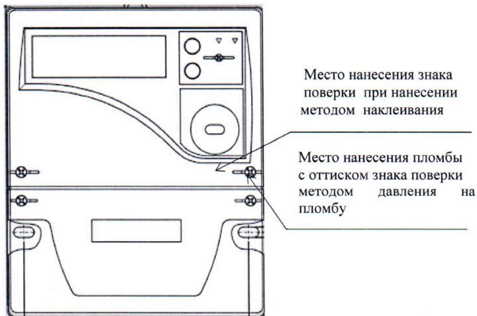
Рисунок 2.1 - Схема (рисунок) с указанием места для нанесения знака поверки на счетчик СЕ318ВУ в типе корпуса R32
