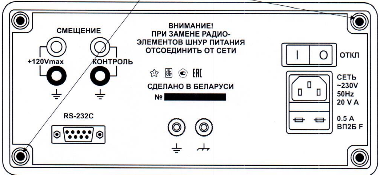
Рисунок 3.1 – Схема пломбировки от несанкционированного доступа
