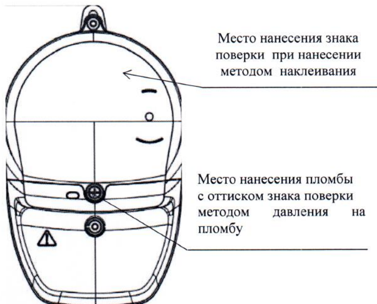
Рисунок 2.1 - Схема (рисунок) с указанием места для нанесения знака поверки на счетчик СЕ208ВУ в типе корпуса S51, S53
