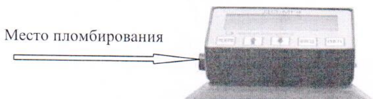
Рисунок 1 – Место пломбирования от несанкционированного доступа
