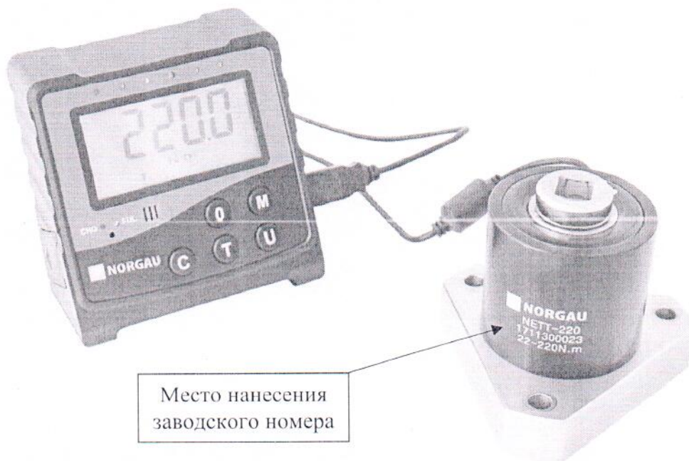
Рисунок 1 – Общий вид измерителей крутящего момента силы NETT
