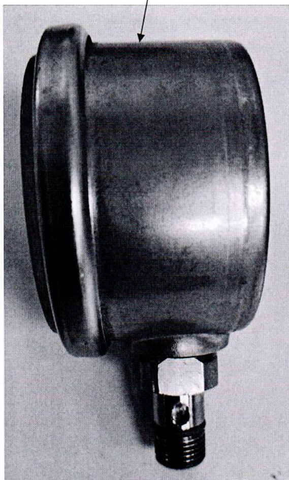
Рисунок 2.1 – Схема (рисунок) с указанием места для нанесения знака поверки средств измерений
