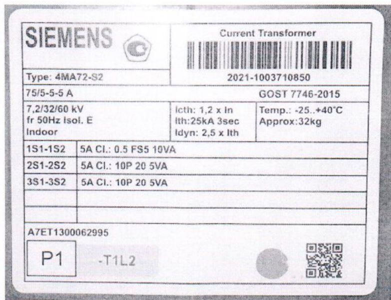
Рисунок 1.2 – Фотография маркировки трансформатора тока 4MA72-S2 АУС № 1003710850
