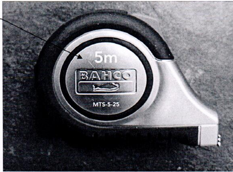
Рисунок 2 – Схема (рисунок) с указанием места для нанесения знака поверки средств измерений
