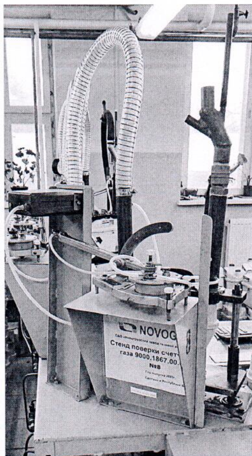
Рисунок 1.1 – Фотографии общего вида стенда поверки счетчиков газа 9000.1867.00.00 № 8
