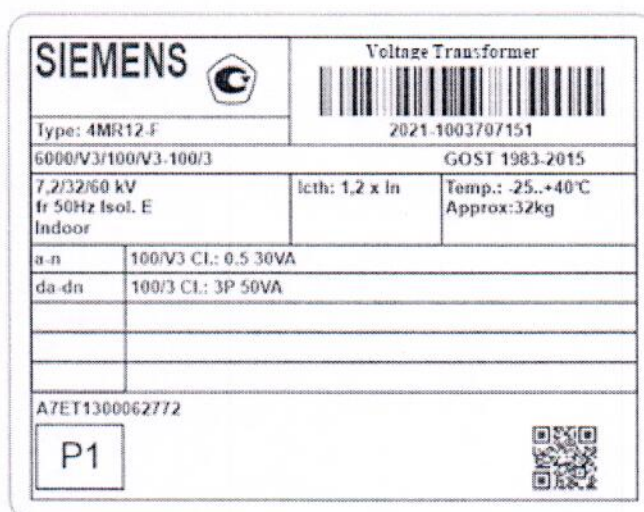
Рисунок 1.2 – Фотография маркировки трансформатора напряжения 4MR12-F АУС № 1003707151
