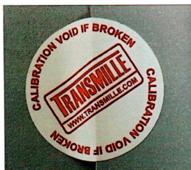
Рисунок 3.1 – Схема пломбировки от несанкционированного доступа (нижняя панель калибратора)
