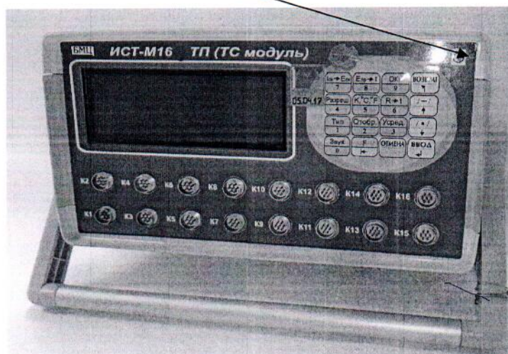
Рисунок 2.1 - Схема (рисунок) с указанием места для нанесения знака поверки для комплексов модификаций ИСТ-М16 (изображения носят иллюстративный характер)
