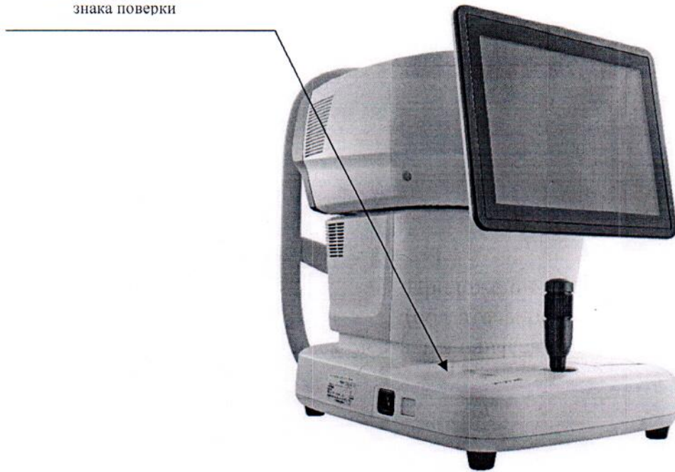
Рисунок 2.1–Схема (рисунок) с указанием места для нанесения знака поверки
