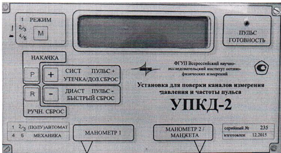
Рисунок 1.1 – Фотография общего вида установки для поверки каналов измерения давления и частоты пульса УПКД-2 № 235
