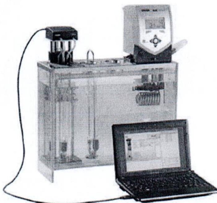
Рисунок 2 – Фотография общего вида системы измерения вязкости автоматической iVisc
