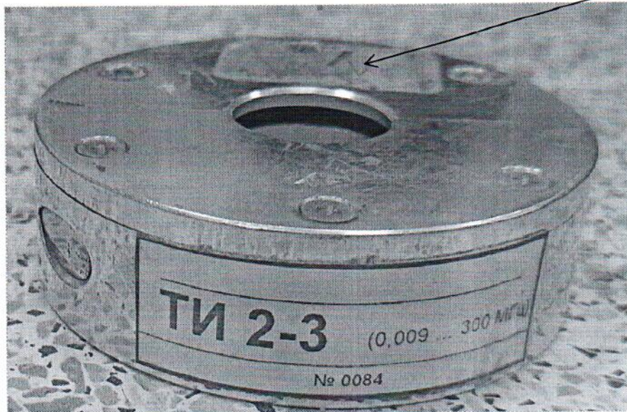
Рисунок 2.1 – Схема (рисунок) с указанием места для нанесения знака поверки средств измерений
