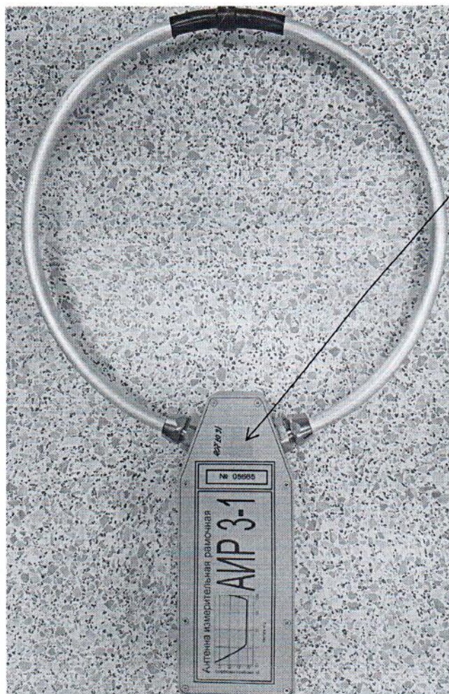
Рисунок 2.1 – Схема (рисунок) с указанием места для нанесения знака поверки средств измерений
