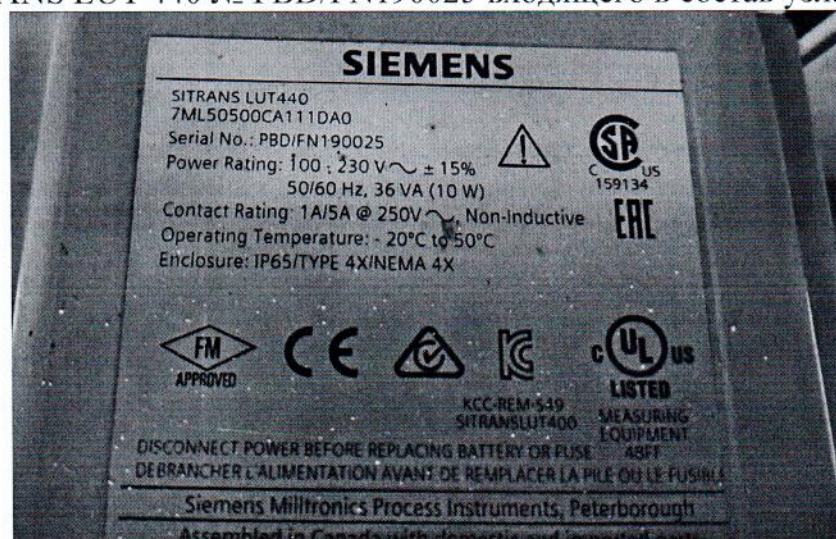
Рисунок 1.2 – Фотография маркировки уровнемера ультразвукового SITRANS LUT 440 № PBD/FN190025 входящего в состав узла учета
