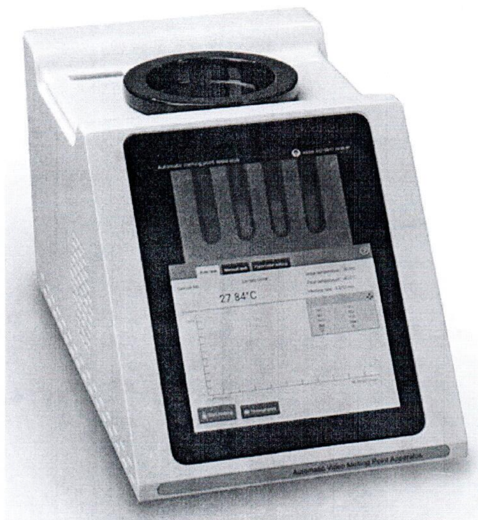
Рисунок 1.1 – Общий вид приборов для определения температуры плавления МР
