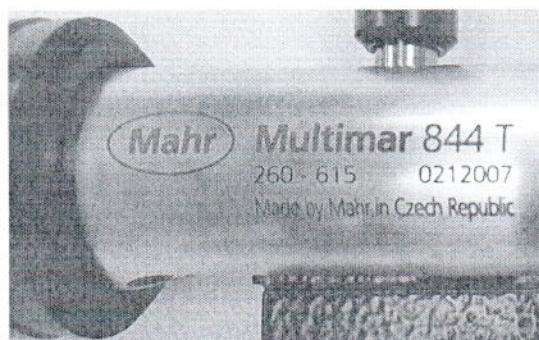
Рисунок 1.4 – Маркировка прибора универсального измерительного Multimar модификации Multimar 844 T (изображение носит иллюстративный характер)
