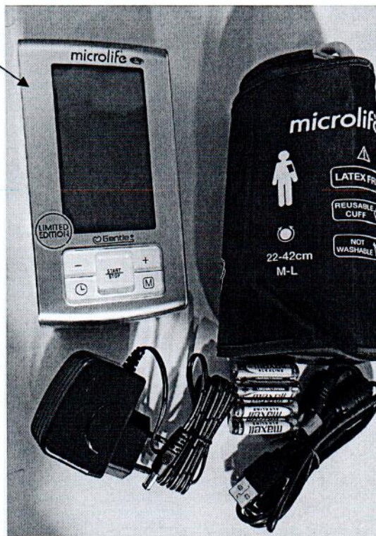
Рисунок 2.8 – Схема (рисунок) с указанием места для нанесения знака поверки на прибор для измерения артериального давления BP A6 BT
