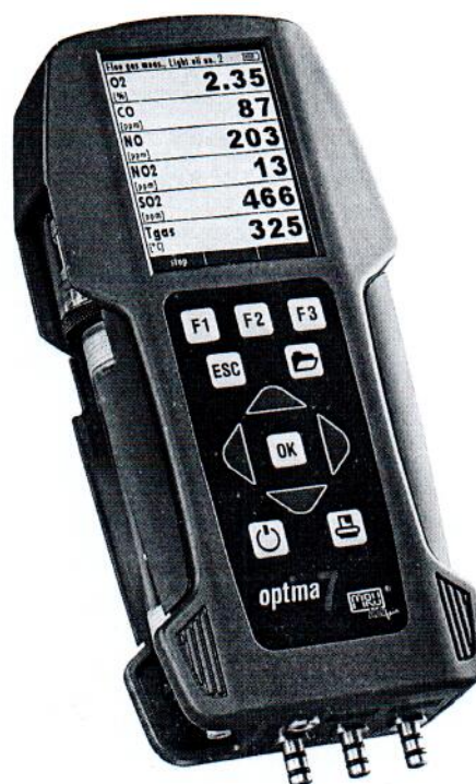
Рисунок 1.2 – Фотография общего вида газоанализатора OPTIMA7 (изображение носит иллюстративный характер)
