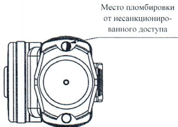
Рисунок 3.1 – Схема пломбировки от несанкционированного доступа (вид снизу)
