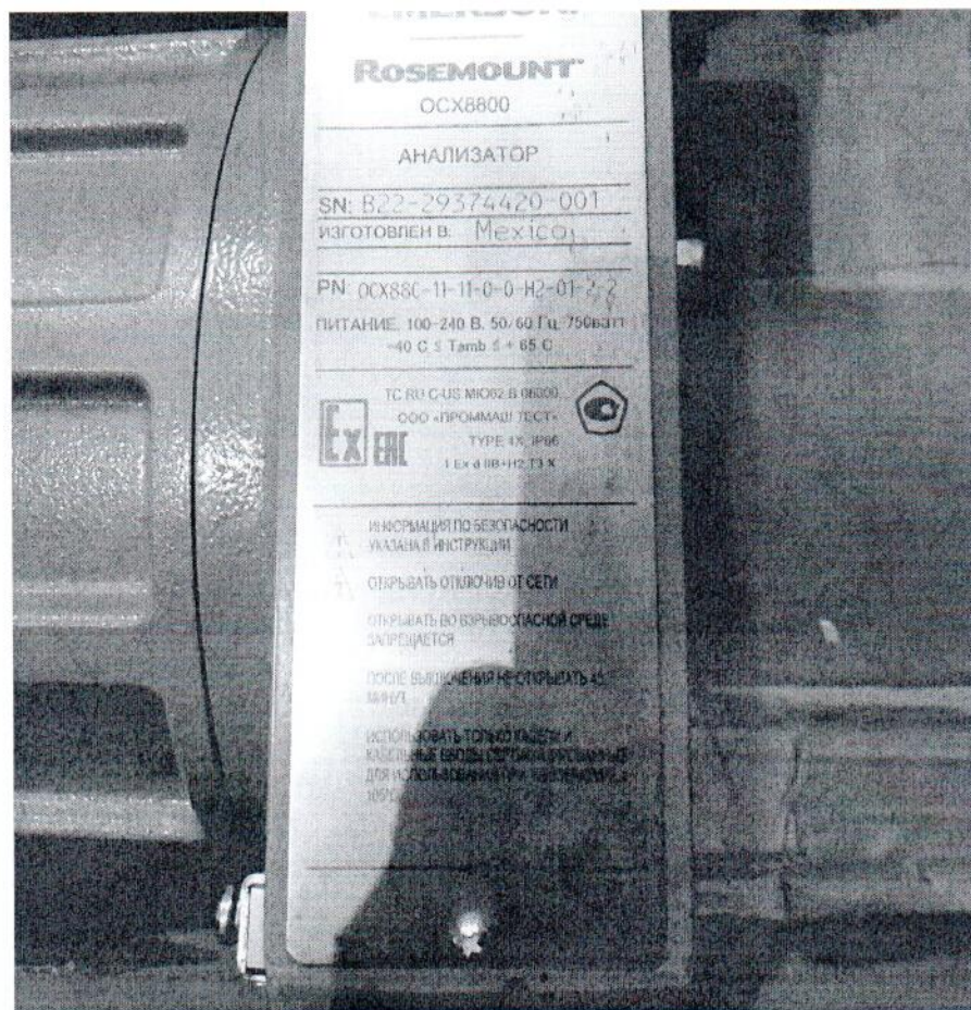
Рисунок 1.2 – Фотография маркировки газоанализатора OX8800 (OXC88C-11-11-0-0-H2-01-2-2) № B22-29374420-001
