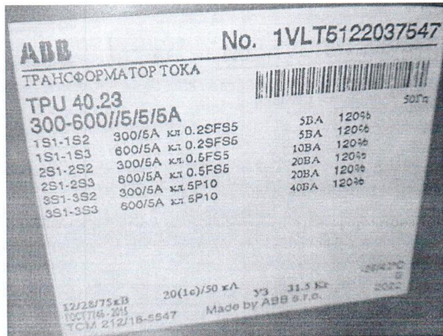
Рисунок 1.2 – Фотография маркировки трансформатора тока TRU 40.23 № 1VLT5122037547
