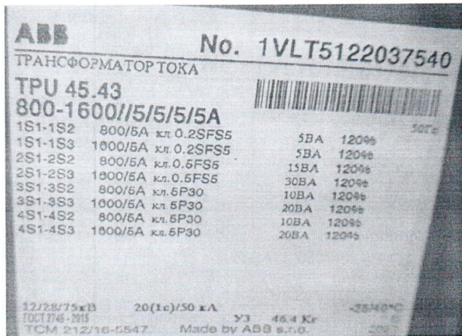
Рисунок 1.2 – Фотография маркировки трансформатора тока TPU 45.43 № 1VLT5122037540
