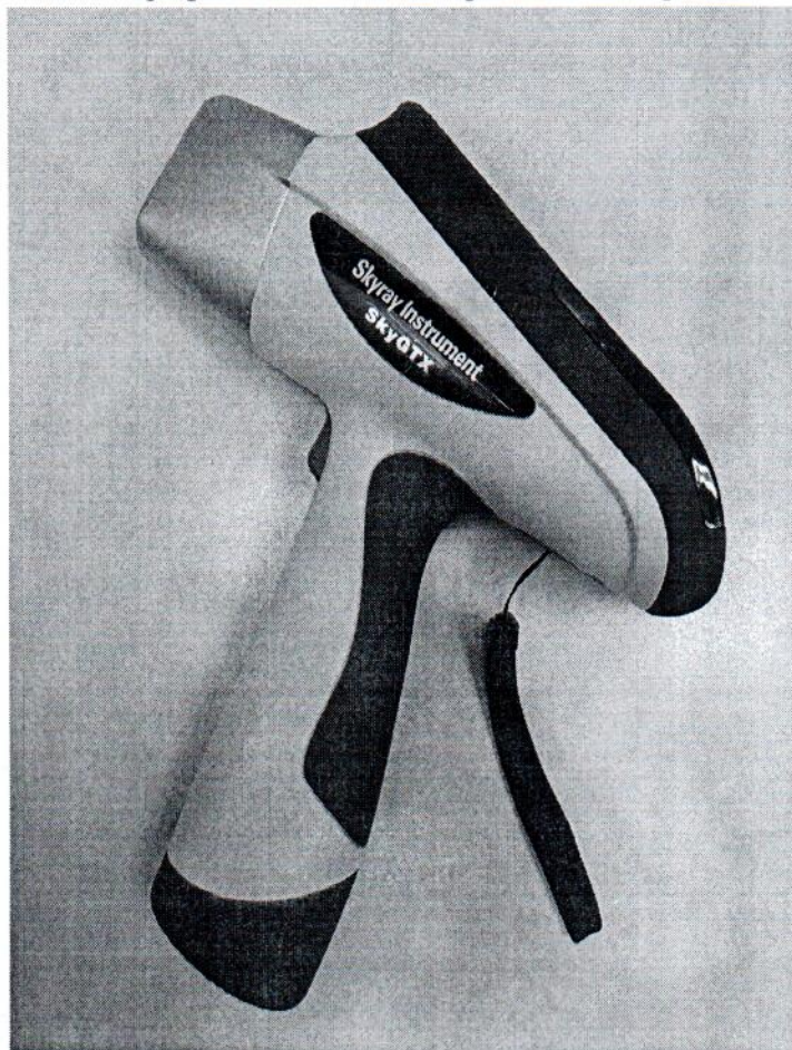
Рисунок 1 – Общий вид спектрометра рентгенофлуоресцентного SkyGTX
