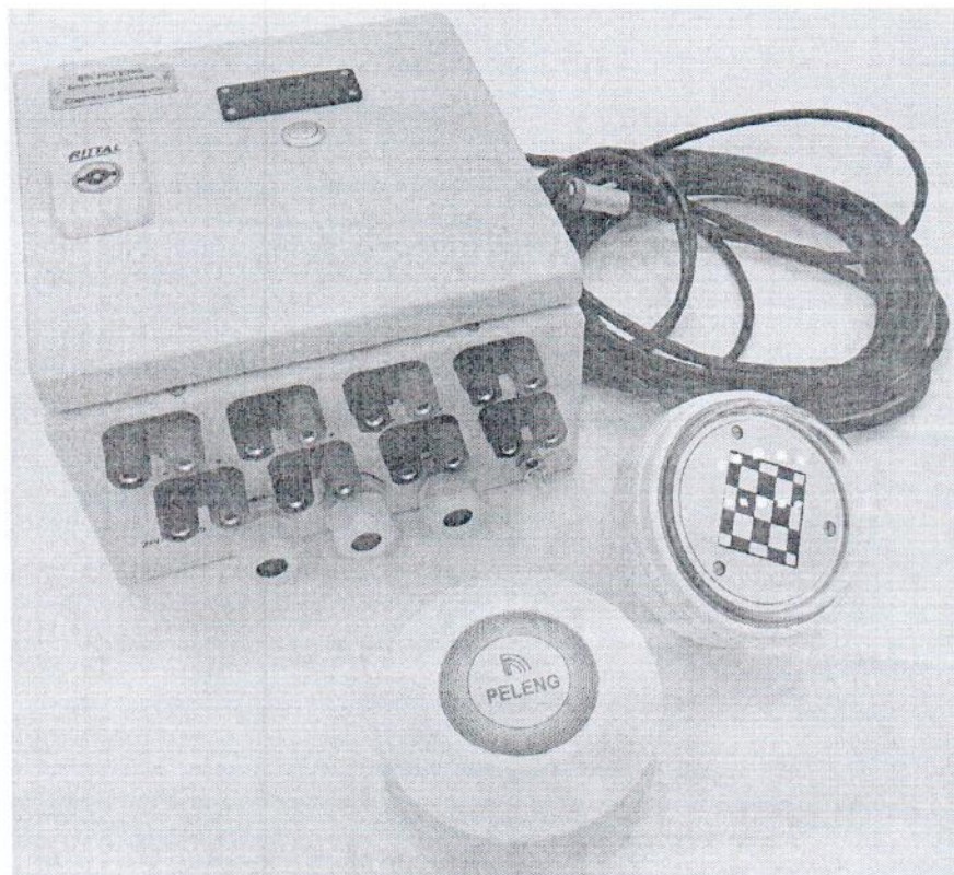
Рисунок 1.1 – Общий вид пиранометров ПЕЛЕНГ СФ-06-21 (в комплектации головка пиранометра АСТ или головка пиранометра АКГ, с блоком электронным и кабелем аналоговых цепей (А)) (изображение носит иллюстративный характер)
