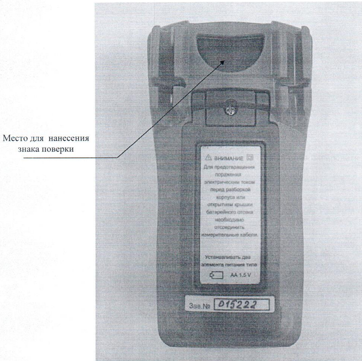
Рисунок 2.1 – Схема с указанием места для нанесения знака поверки (изображение носит иллюстративный характер)
