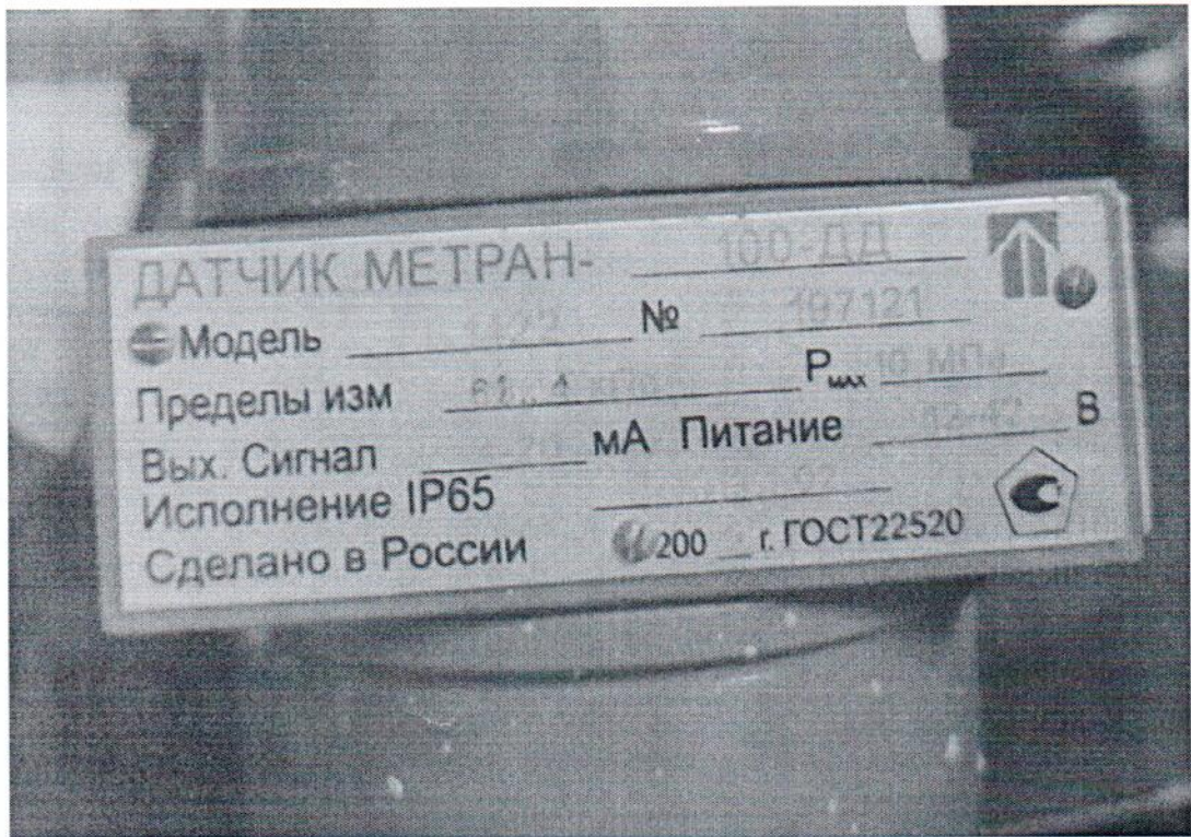
Рисунок 1.4 – Фотография маркировки датчика давления Метран-100-ДД, модель 1422, № 197121 входящего в состав системы учета (резервный комплект)
