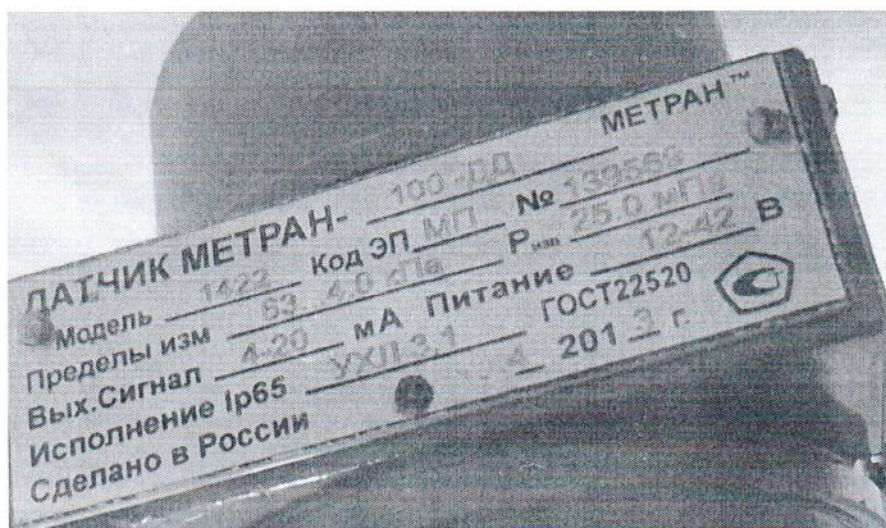
Рисунок 1.2 – Фотография маркировки датчика давления Метран-100-ДД, модель 1422, № 139569 входящего в состав системы учёта (основной комплект)
