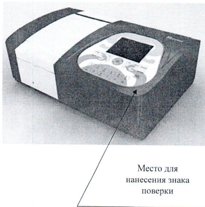
Рисунок 2.4 – Место нанесения знака поверки на спектрофотометры i9
